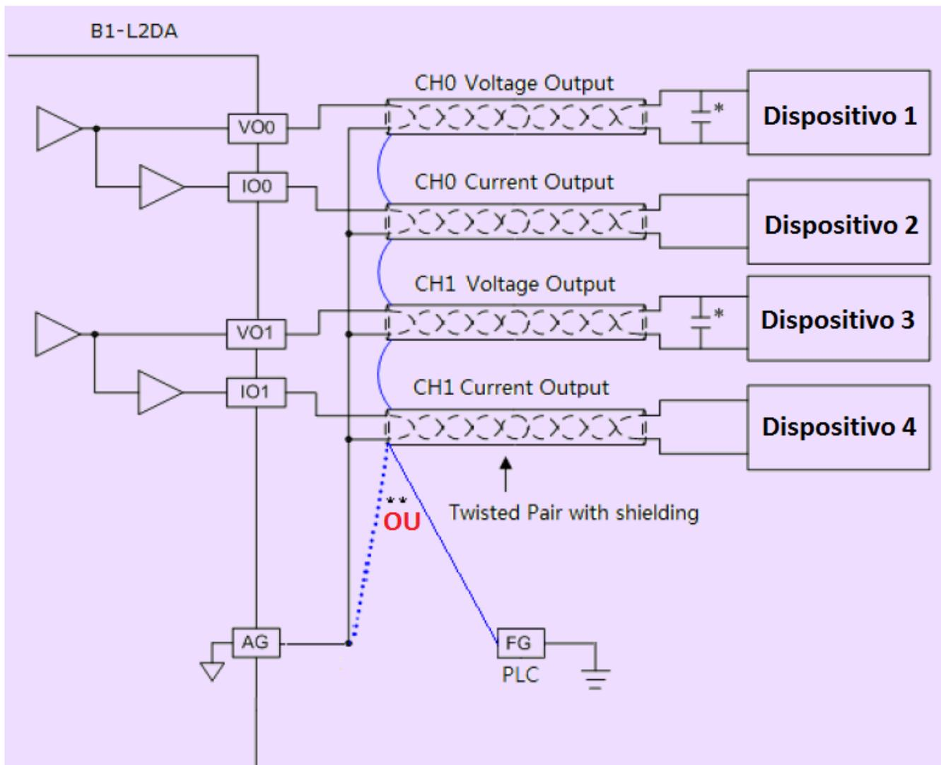
\* Sugestão de instalação: Capacitor 0,1 ~0,47 uF (para filtrar ruídos). Não obrigatório.
