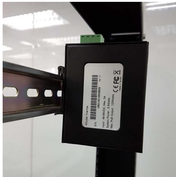
Estabilizar el interruptor en el carril DIN
