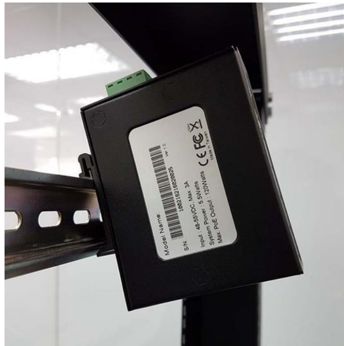
Inserte el soporte en el riel DIN
