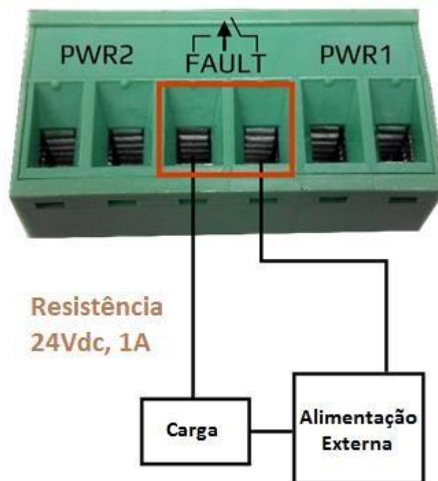
Conexión del contacto de alarma de avería
