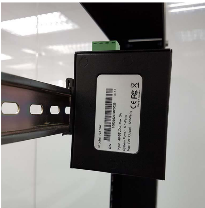
Estabilice el convertidor de medios en el riel DIN
