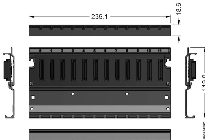
Figura 4: Bastidor 12 Posiciones
