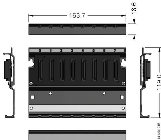
Figura 3: Bastidor 8 Posiciones
