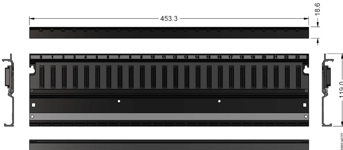
Figura 6: Bastidor 24 Posiciones
