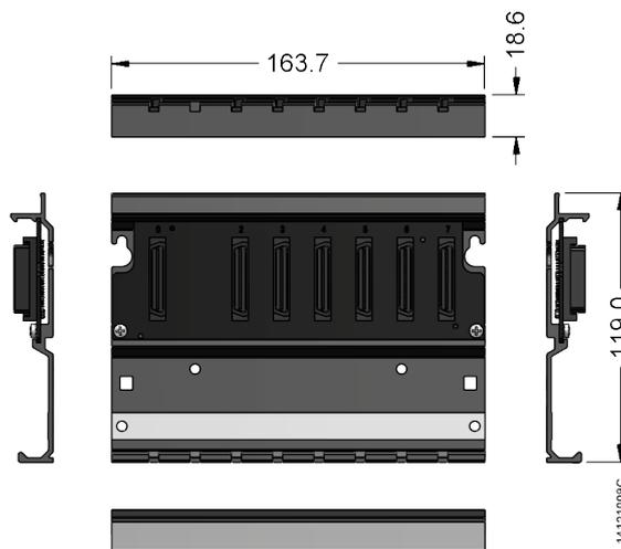
Figura 2: Bastidor 8 Posiciones sin Sustitución en Caliente
