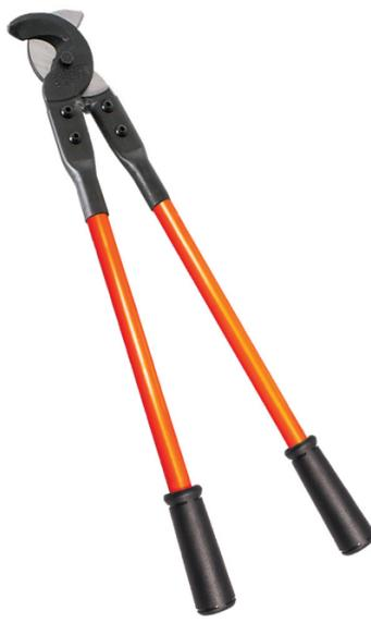
Los cortadores multicable Klein Tools estándar son livianos y eficaces. Cuentan con cuchillas reemplazables con mordazas tipo gancho que agarran y sostienen el cable, mientras que la acción de corte por cizalla hace cortes perfectos. Las mordazas son de acero forjado para herramientas, con un acabado de óxido negro para prolongar la duración. Los mangos de fibra de vidrio excepcionalmente resistentes tienen agarres de vinilo pesado para lograr mayor comodidad y resistencia al deslizamiento.
