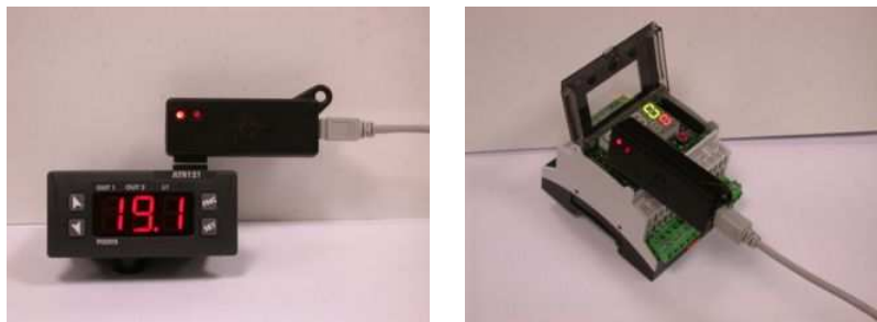
Figura 14: inserimento memory per ATR121 (sinistra) e DRR245 (destra)
