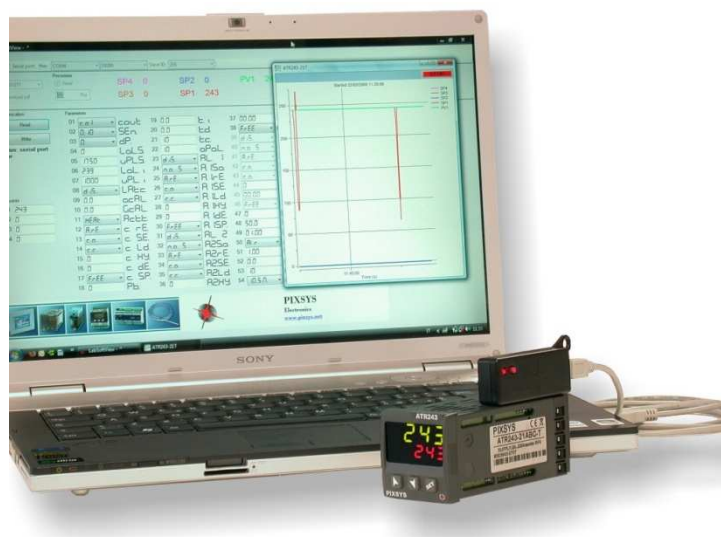
Figura 12: il kit LabsoftView usato per collegare un ATR243 ad un pc
