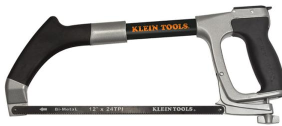
El arco para segueta de alta tensión de 12" (304,8 mm) de Klein Tools tiene una tensión ajustable de la hoja de hasta 30 000 psi para hacer cortes rápidos y precisos. Incluye hoja bimetálica de sierra para metales de 12" (305 mm) x 24 dientes por pulgada y hoja bimetálica de sierra con movimiento alternativo de 6" (152 mm) x 24 dientes por pulgada También cuenta con cómodo almacenamiento de hojas en el mango y agarre suave al tacto.
